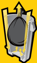
CONDUITS D'AÉRATION INTÉGRÉS
